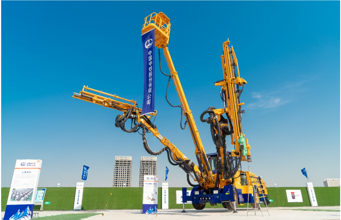
图 20: 智能型三臂凿岩台车-是隧道钻爆孔施作的国内外技术领先的设备, 具有智能化程度高, 破岩速度快等特点, 其应用可将川藏铁路智慧隧道建设提升一个新高度。
